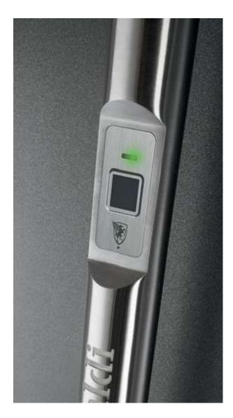
**3.** Für das Einspeichern des Fingerabdrucks muss die LED Anzeige auf der Programmeinheit blau blinken. Drücken Sie die Taste (**G 2**). Nach dem Drücken bitte innerhalb von 10 Sekunden den Finger auf den Fingerscanner legen. Beim erfolgreichem einspeichern des Fingerabdrucks leuchtet die LED Anzeige am Fingerscanner grün und auch ein Bestätigungston.
